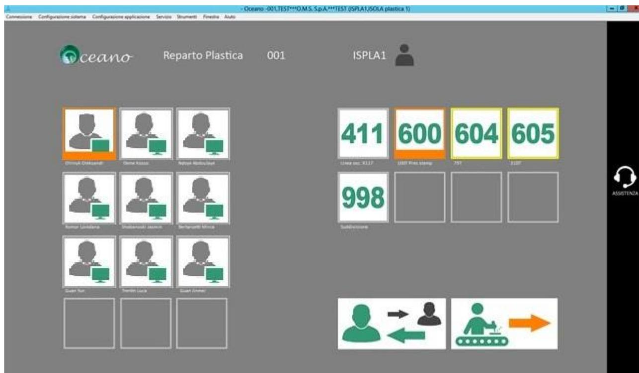
Fig.2 Dettaglio del MES: area di selezione delle matricole e dei centri di lavoro.
